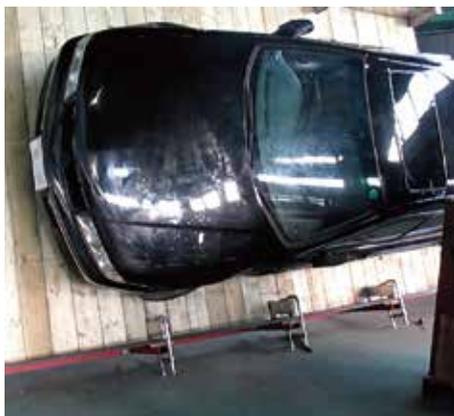
カーシェルター床部に1.7tの車を固定し90°倒してもOK
